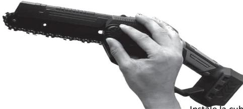
Instale la cubierta lateral y apriete ligeramente la tuerca del tornillo.
