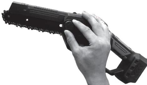
Después de aflojar la tuerca de compresión en sentido antihorario, retire la cubierta lateral de compresión.
